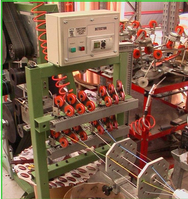
Il dispositivo permette di monitorare la presenza del filo o del cavo in condizione di lavoro. La fine bobina, la rottura cavo/filo e la condizione errata di posizione del prodotto daranno un segnale di allarme che verrà gestito da un P.L.C. dedicato.
